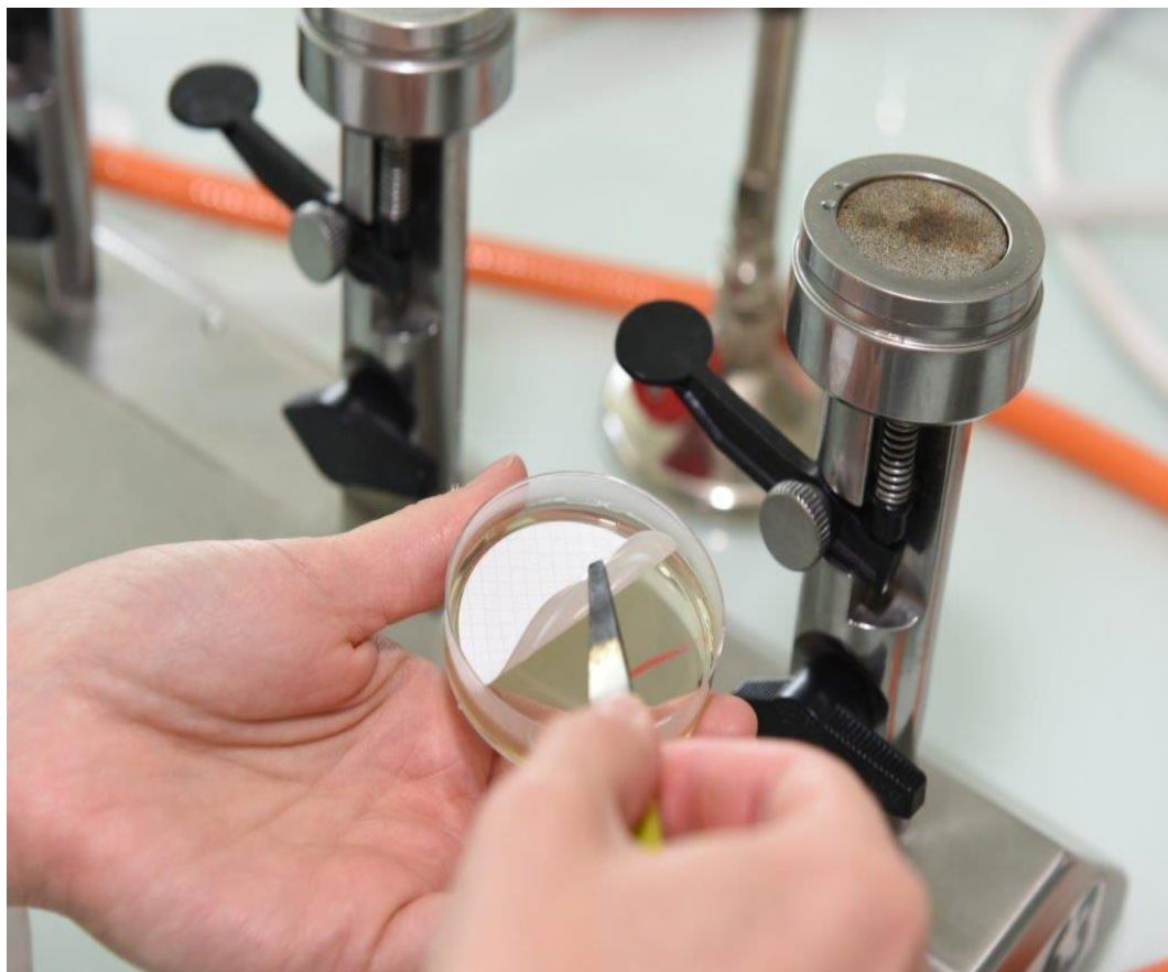
Figure n 7: Dénombrement des germes par filtration ( https://www.ladromelaboratoire.fr/domaines-dexpertises/eau-et-environnement/microbiologie/ )
