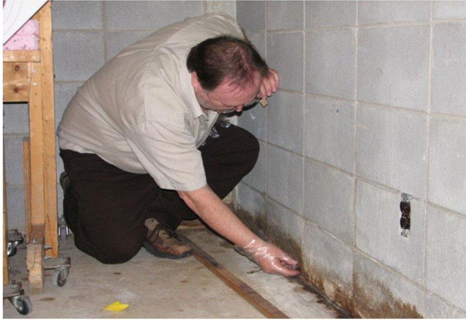
Figure n3: Prélèvement de surface par des lames de contact
