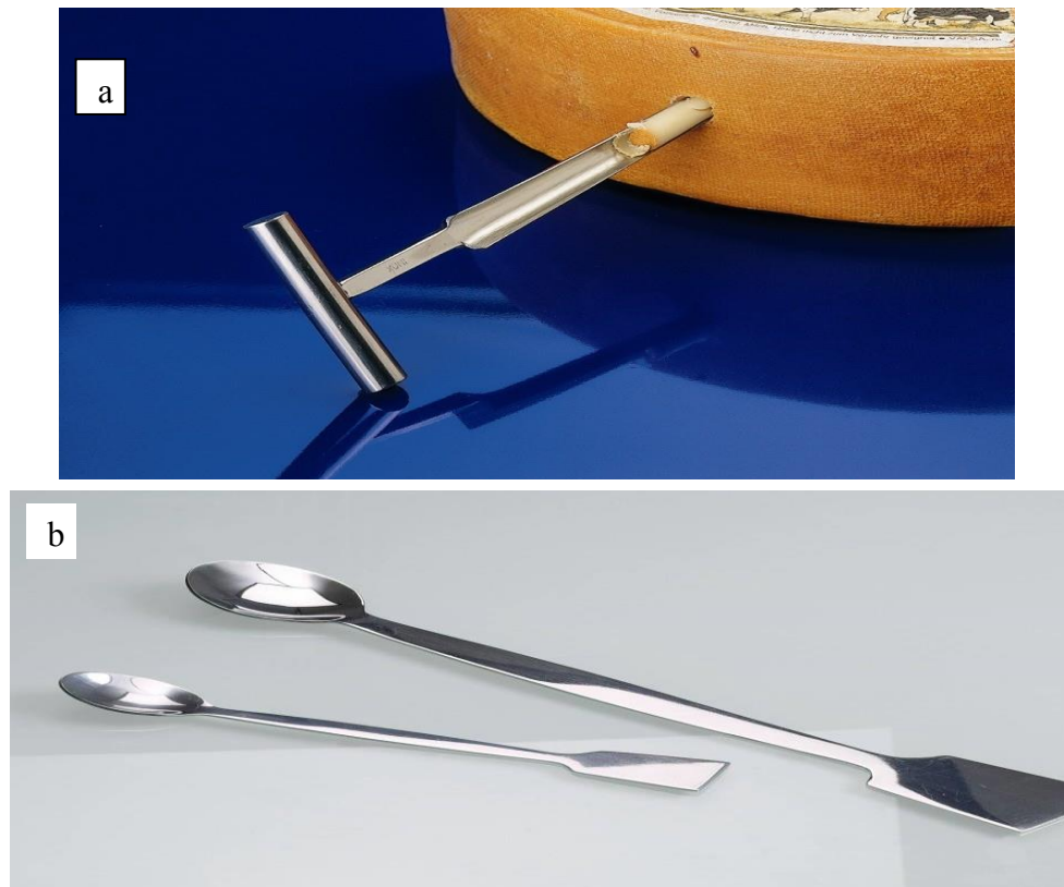
Figure n4: Prélèvement des produits solides.
