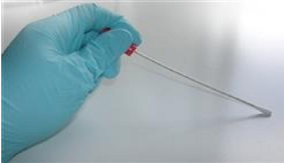
Figure n2: Prélèvement en surface par écouvillonnage
